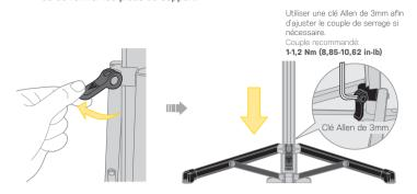
Fermer le crochet et le glisser afin d'ajuster la hauteur. Ouvrir le crochet afin de le bloquer à la position voulue.
