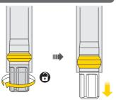
Drehen Sie den Drehverschluss, um den Gummiring zu entspannen und entnehmen Sie die Pumpe.
