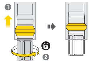
將打氣筒放進座管後，旋轉握把並擴張橡膠墊圈，即可固定（請勿將打氣筒完全放進座管中，請預留握持空間，以便取放）
